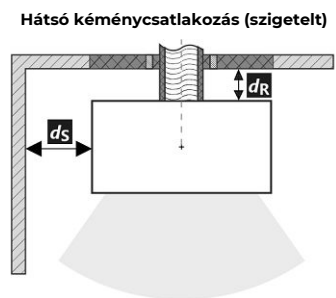
A füstcső áthaladása éghető anyagból készült falon
